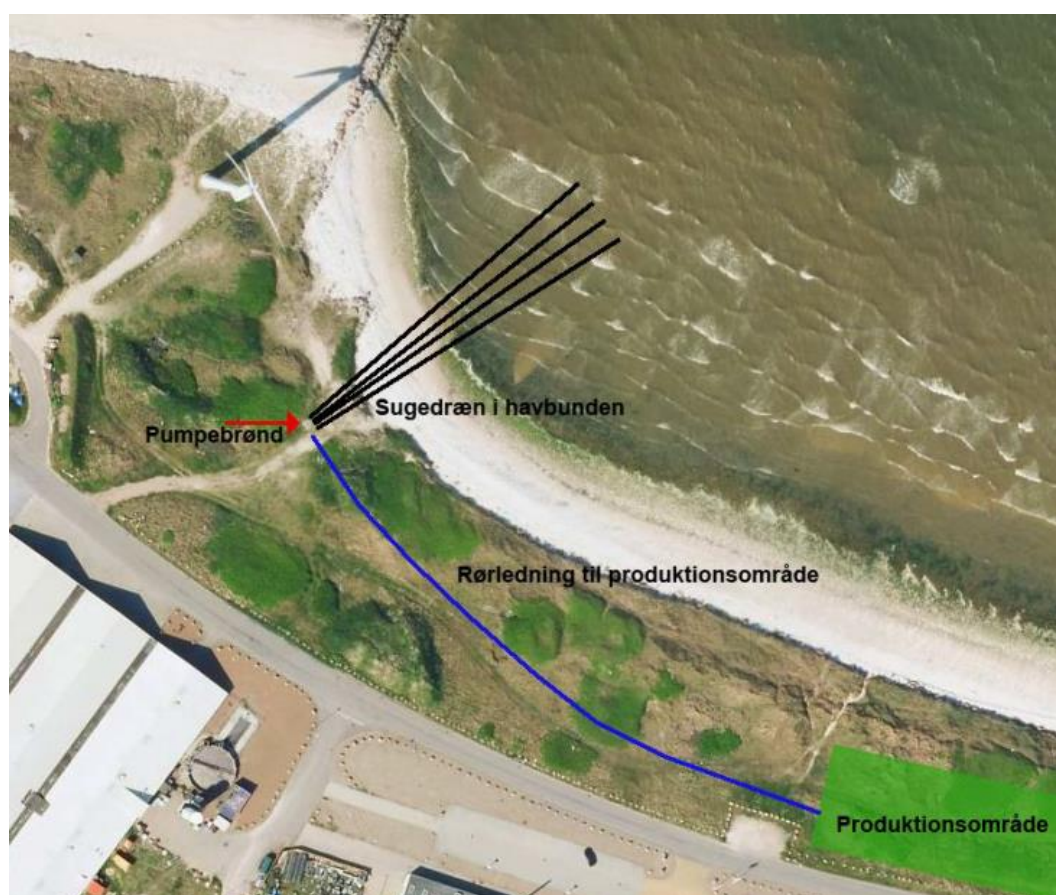
Figur 14-2. Placering af dræn i havbund ved Roshagen til forsyning af RDS Aquaculture med saltvand.
