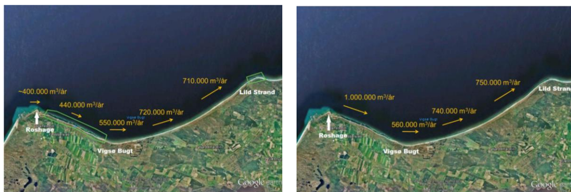
Figur 7-5. Tv.: Vurderede sandtransportmængder langs kysten nedstrøms Hanstholm Havn. Th.: Beregnede sedimenttransportkapaciteter baseret på lokale bølgeforhold (bølgehøjder og -retning). 77
